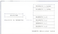
Figura 2 - Un registro di segmento è in realtà un puntatore («seletores») ad una di 2024 voci di una tabella. Ogni voce di ampiezza 4 byte e contiene informazioni riguardanti il segmento puntato.
